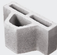
ECOBLOCO SM02 L39 X A19 X P14 CM 12,5 PEÇAS/M 2 - 15 KG
