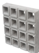
ELEM.T. VAZADO 16 FUROS 3D LM06 L40 X A44 X P7 CM 6 PEÇAS/M 2 - 16,7 KG
