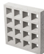
ELEMENTO VAZADO 16 FUROS LM09 L39 X A39 X P7 CM 6,25 PEÇAS/M 2 - 15,50 KG
