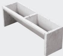
ECOBLOCO SM03 L65 X A22 X P19,5 CM 7 PEÇAS/M 2 - 21 KG
