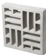
ELEMT. VAZADO TACO CHINÊS LM10 L39 X A39 X P7 CM 6,25 PEÇAS/M 2 - 15 KG
